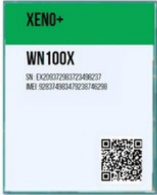
XENO+ ML SOM with WiFi+BLE and LoRa (26 x 32 x 5 mm)
