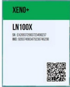
XENO+ ML SOM with LTE (32 x 38.5 x 5 mm)
